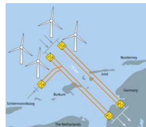
Offshore-Windpark mit HGÜ-Anbindung (Siemens)
