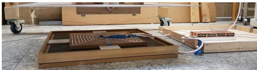
Aufbau einer Testspule
