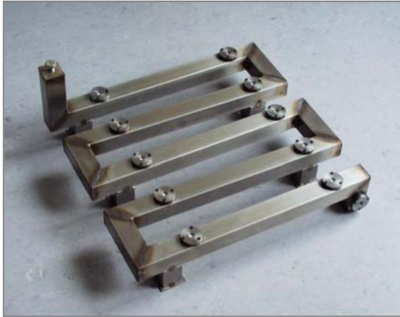
**Bild 2** Versuchsaufbau zur Messung des Selbstdiffusionskoeffizienten in Öl
