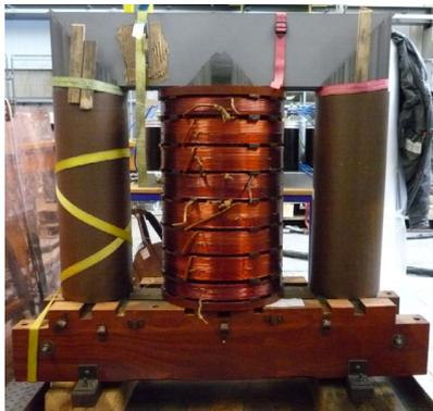
**Bild 10** Aktivteil eines Verteiltransformators mit intakter OS-Wicklung
