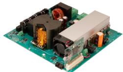
In dieser Abschlussarbeit soll der DC/DC-Wandler zur Anbindung der Brennstoffzelle entworfen, aufgebaut und in Betrieb genommen werden. Der DC/DC-Wandler soll dabei die Betriebsführung der Brennstoffzelle unterstützen und eine Integration in das übergeordnete Energiemanagementsystem des DC-Microgrids ermöglichen.
