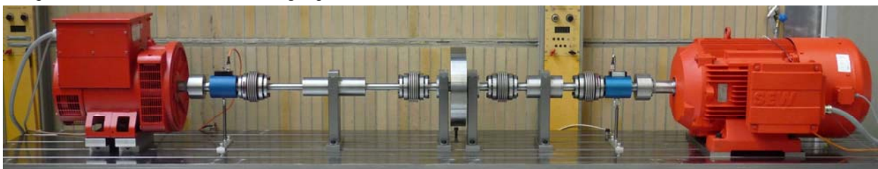
Bild 6 Mechanischer Aufbau des experimentellen Versuchsfeldes
