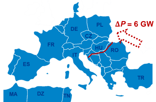
Abb. 1 Beispiel für Systemauf-trennung (08.01.2021) und resultierendes Leistungsungleichgewicht
